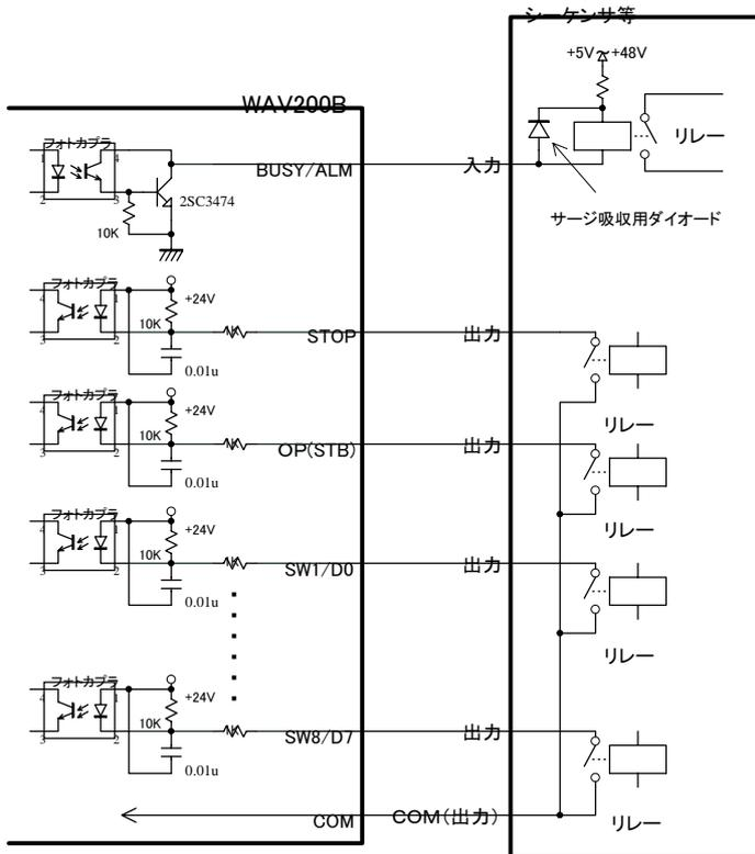
リレーのコイルをドライブする時はコイル間にサージ吸収用のダイオード（繰り返し尖頭逆電圧及び直流逆電圧は、外部のサージも考慮して余裕のあるもの、また平均整流電流はコイル電流以上のダイオード）を付加して下さい。
