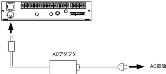
付属品の AC アダプタを商用電源(AC100V 50/60Hz)と接続します。
