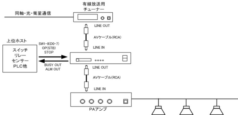
17. 制御・監視用接点端子の接続
