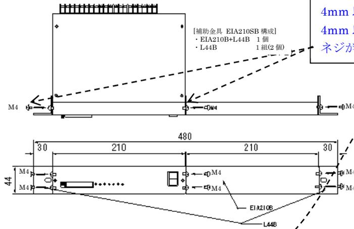
装置側面へのネジは、外側端面から
