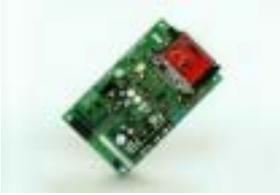
WAV520Bは、音源にWAVEファイル、記憶媒体にCFカード、3段階音量切替機能、5Wスピーカーアンプを搭載した小型・低価格なWAVEファイル再生ボードです。WAVEファイル、CFカード採用、無償WEB配布のサポートソフトにより、本ボードを採用した機器メーカー、サービス会社はもとよりクライアント自身でも音源データの登録・変更ができます。6650V2/VF2の互換モデルです。(サイズ/コネクタ互換、制御モード互換)
