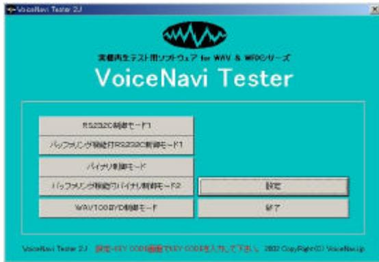
本ソフトは Windowsパソコンで WAVシリーズ、WRXシリーズの実機をバイナリ制御、RS232C 制御で再生テストするソフトです。
