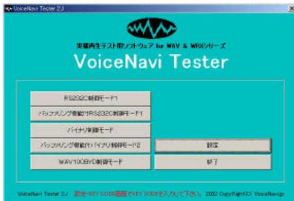
メニュー画面で実機に合わせて、再生制御モードを選択しますと、各再生テスト画面に切り替わります。
