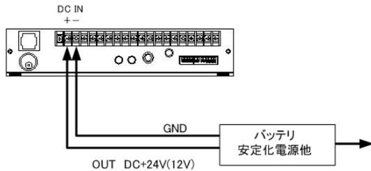
バッテリーなどノイズが少ない安定化電源に接続します。
