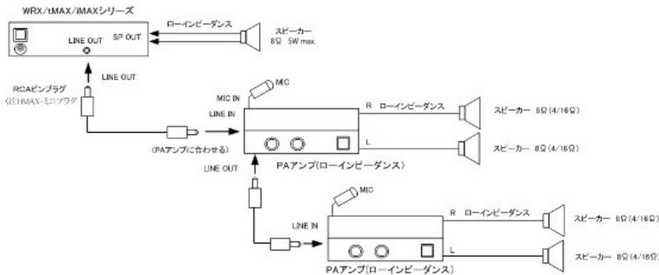
**【ローインピーダンス用拡声アンプ】** (注)PA メーカーの PA アンプもハイ/ローインピーダンス出力の設定可
