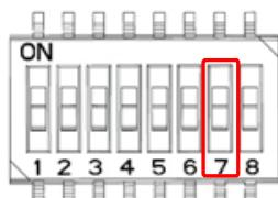
No.7 で設定します。 電源 OFF 状態で設定してください。(電源 ON 時に読み取)
