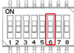
No.6 で設定します。 電源 OFF 状態で設定してください。(電源 ON 時に読み取)
