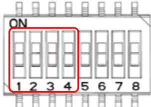
1～4で設定します。電源OFF状態で設定してください。(電源ON時に読み取り)
