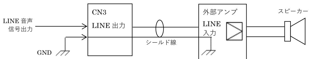
※ 本機のLINE出力は不平衡（片側GND接地）出力です。
