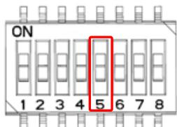
No. 5 で設定します。 電源 OFF 状態で設定してください。(電源 ON 時に読み取)
