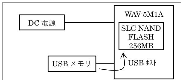
USB メモリからのデータ取り込みモードに設定して電源 ON すると、USB メモリ内のデータを内蔵 NAND FLASH メモリにコピーできます。その後、NAND FLASH からの再生モードに設定して再起動すると、USB メモリ不要で再生できます。
