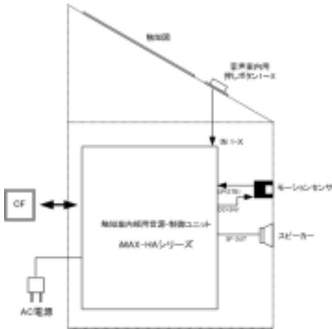
モーションセンサ(反射型赤外線センサ)対応
