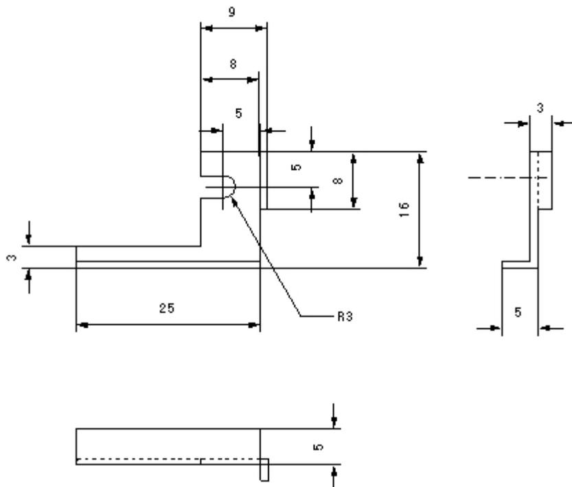
[取付方法] WAV570B の取付穴を利用して金具を固定します。
